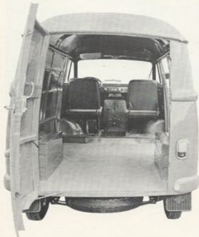
Kastenwagen mit Durchgang vom Fahrerhaus zum Laderaum
